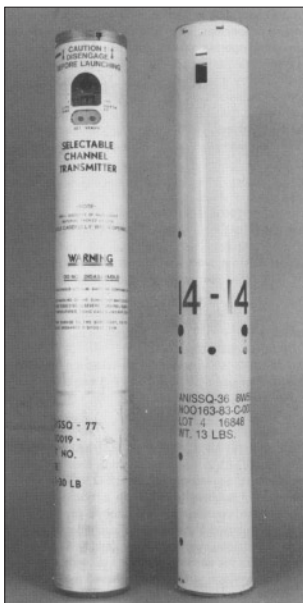
Радиогидроакустические буй AN/SSQ-36 (справа) и -77 (слева)
