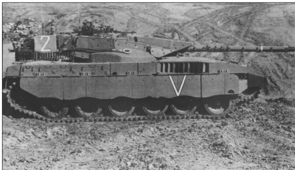
Израильский ОБТ «Меркава» Mk.3 с модульным бронированием
