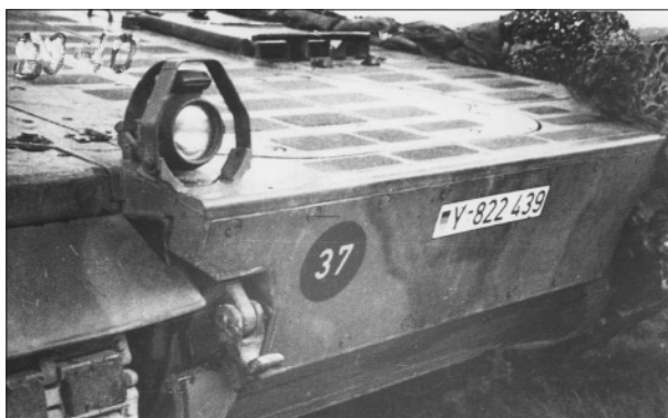
Лобовое бронирование германской БМП «Мардер», усиленное дополнительными броневыми листами
