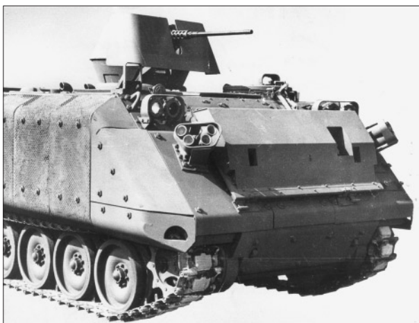
Американский БТР М113А3, оснащенный комплектом навесной пассивной брони Р-900
