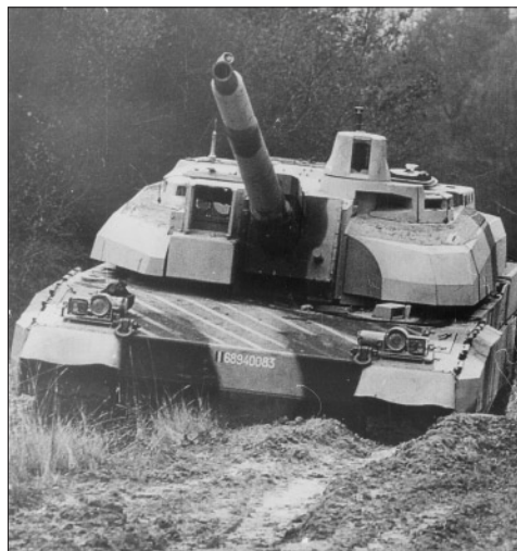
Французский ОБТ «Леклерк», имеющий модульное бронирование
