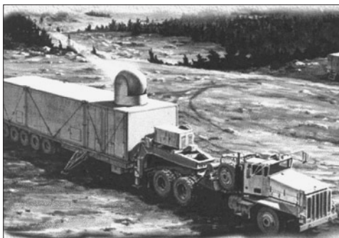
Рис. 2. Тактический лазерный комплекс TNEL на базе буксируемой платформы
