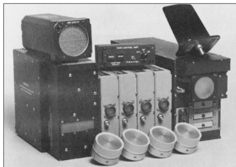
Комплекс радио- и радиотехнической разведки AN/ALR-66C/V/5
