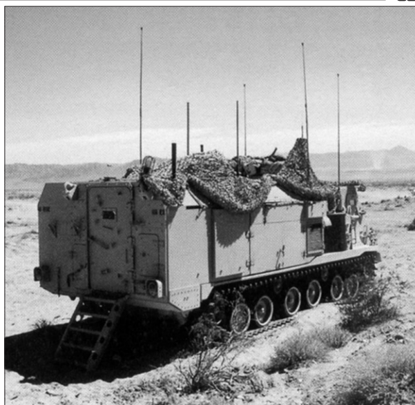
Боевая машина управления VCV на базе БМП М3 «Брэдли» для командиров боилад и пехотных подразделений
