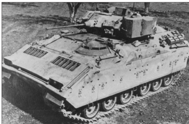
Американская БМП «Брэдли» с установленной навесной броней
