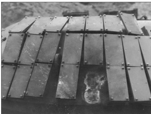
Контейнер динамической защиты башни танка после обстрела бронебойно-подкалиберным снарядом
