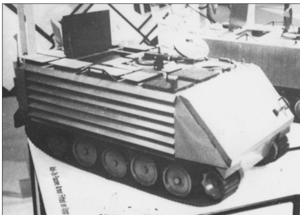
Макет БТР М113 с комплектом дополнительной брони израильской фирмы «Рафаэль»
